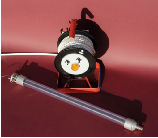
■ Abb. 7.7 Kabellichtlot mit angeschlossenem Probenheber zur Entnahme von MKW-kontaminierten Grundwasserproben (Foto H.-P. Steyrer)
